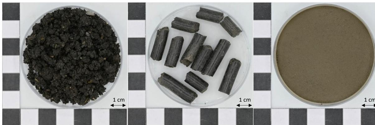
Abbildung 4.1: Stichprobe von entwässertem Klärschlamm (links), Klärschlamm pellets (Mitte) und Zerkleinerungsrückstand aus der Scheibenschwingmühle (rechts).
