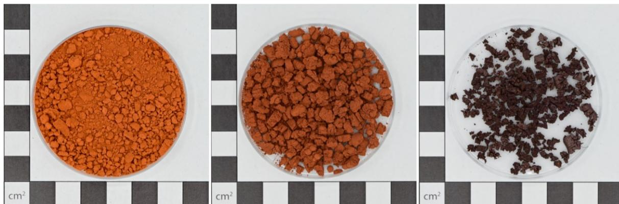
Abbildung 5.6: Klärschlammasche nach Verbrennung von 10 g Klärschlamm ohne Zugabe von Additiven im Muffelofen bei 850 °C (links), 950 °C (Mitte) und 1.050 °C (rechts).
