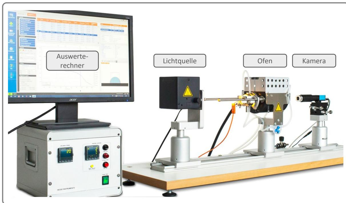
Abbildung 4.4: Darstellung des Erhitzungsmikroskops EM201 der Firma Hesse Instruments. Quelle: Hesse Instruments [147].
