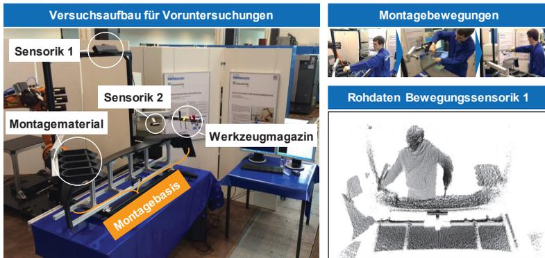
**Bild 4-12: Versuchsaufbau zur sensorischen Erfassung einer Schraubmontage**
