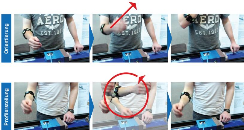
**Bild 4-29: Gesten zur bedienerspezifischen Kalibrierung**
