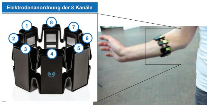
**Bild 4-27: Myo Sensor-Armband**
