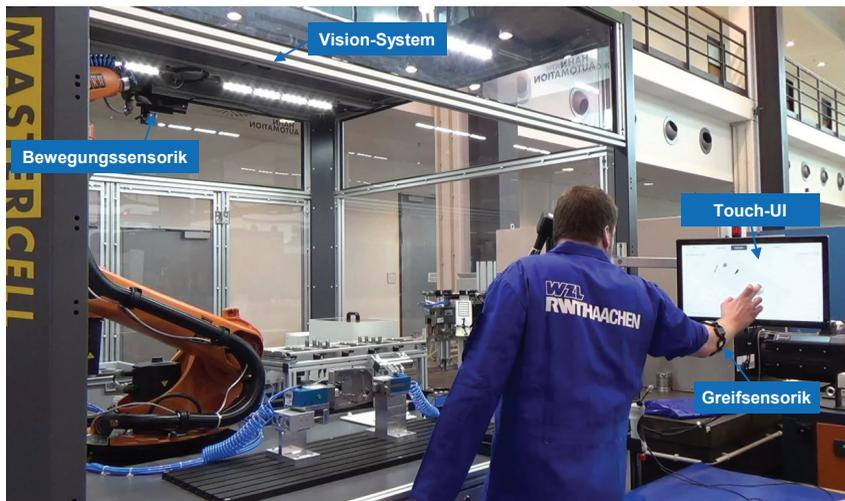
**Bild 6-7: Aufbau des Interaktionsdemonstrators**
