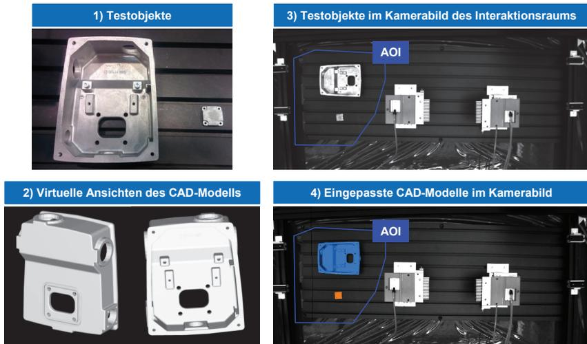
**Bild 4-31: 3D-CAD-Modell basierte Lokalisierung von Testobjekten im Interaktionsraum**
