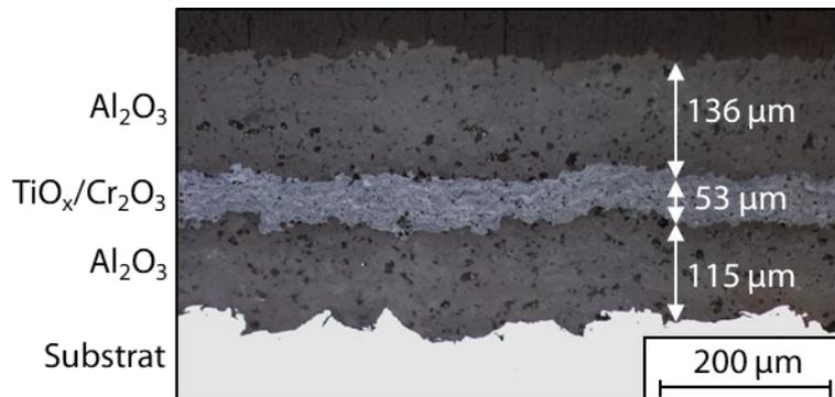
Abbildung 38: Lichtmikroskopischer Querschliff des Heizschichtsystems mit dem Parameter S15 [BWK+20]
