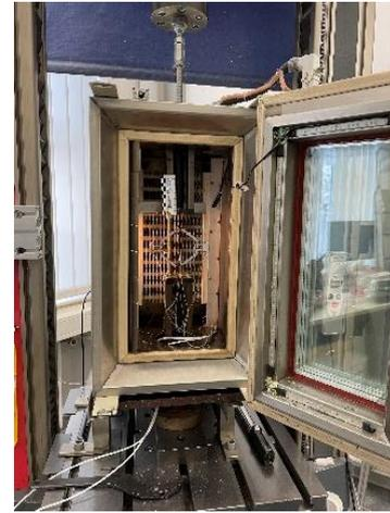
Abbildung 7 Versuchsaufbau zur Bestimmung der Zugfestigkeit unter externem Temperatureinfluss
