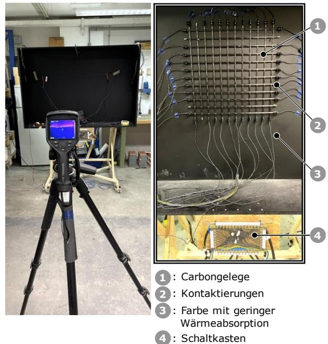
**Abbildung 4** a) Versuchsaufbau zur Wärmeverteilung der CG b) exemplarisch für C-EP
