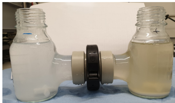
Abbildung 8.3: Fest-Flüssig-Gleichgewicht von L-Alanin in Wasser in Abhängigkeit des pH-Werts [121, 122]. Elektrolytlösungen mit den Kristallen nach der elektrochemischen pH-Shift Kristallisation von L-Alanin
