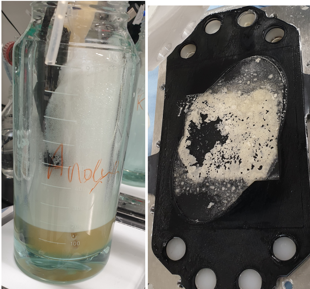
Abbildung 8.33: Kontinuierliche elektrochemische pH-Shift Kristallisation von Bernsteinsäure aus Fermentationsbrühe: Links die Sachumbildung und rechts die feste Kristallschicht vor der Anode in dem 8 mm Prototyp bei T = 20^{\circ}\text{C} , j = 0,1 \text{ A/cm}^2 und \tau = 7,5 \text{ s} .
