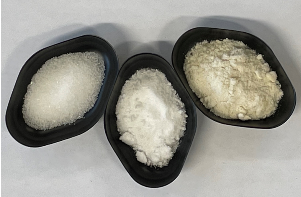
Abbildung 6.19: Optischer Vergleich der kontinuierlich produzierten Bernsteinsäure aus artifizieller Lösung (Mitte) und aus Fermentationsbrühe (Rechts) mit kommerziell erhältlicher Bernsteinsäure (Links).
