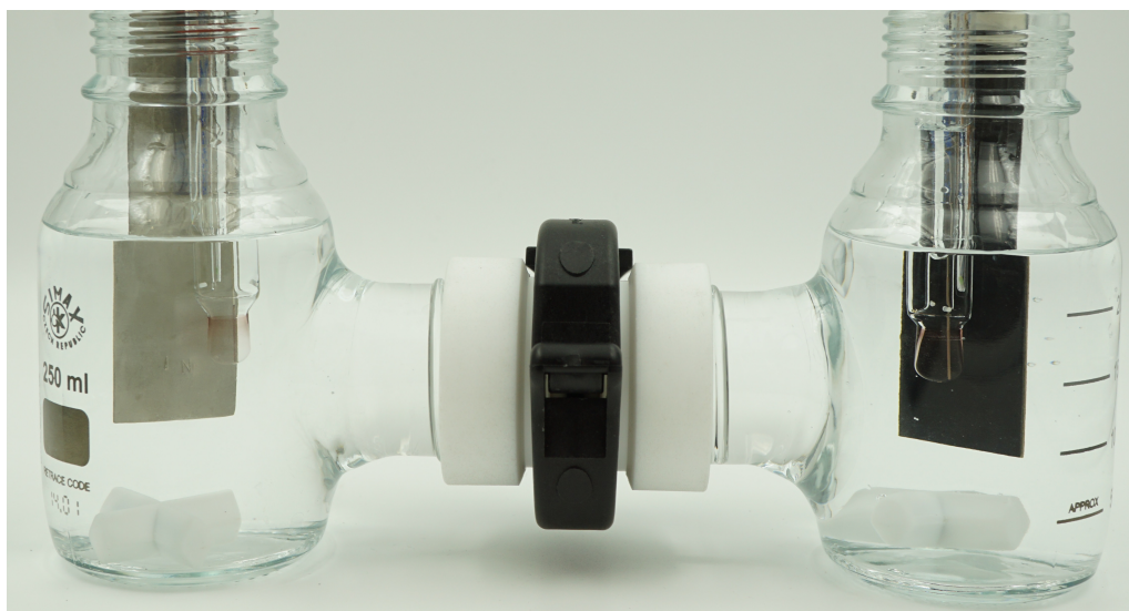
Abbildung 3.2: H-Zelle für die Machbarkeitsstudien. Die Anodenkammer mit der pH-Sonde, dem Rührfisch und der mit Iridiumoxid (IrOMM) beschichteten Titanelektrode, befinden sich auf der rechten Seite. Als Kathode auf der linken Seite fungiert ein Nickelblech. Beide Kammern sind durch eine Fumapem 14100 Kationenaustauschermembran voneinander getrennt.
