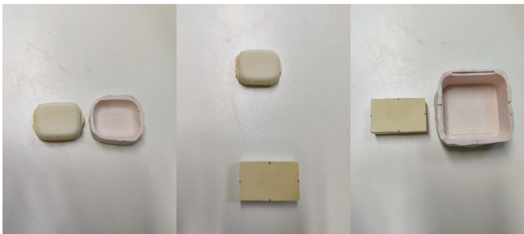
Abbildung 8: Abdrücke und Gipsmodelle als Basis für die Sensorhalterungen
