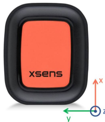
Abbildung 25: Sensor-Koordinatensystem (S) (Xsens DOT User Manual, S. 19)
