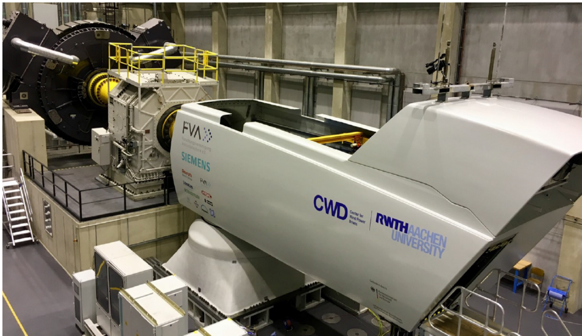
Abb. 1.2: Systemprüfstand des CWD der RWTH Aachen mit darauf installierter Forschungs-windenergieanlage [M5]
