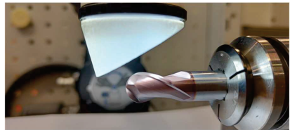
Figure 2-9: Direct offline measurement of cutting tool wear using a microscope Direkte Offline-Messung von Zerspanwerkzeugverschleiß mit Mikroskop
