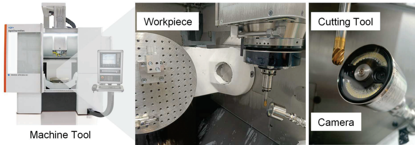
Figure 6-5: Machine tool Mikron HPM800U-HD and integration site with inline camera Werkzeugmaschine Mikron HPM800U-HD und Integrationsort mit inline Kamera
