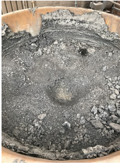
Abbildung 75: Gleichgewichtsnah erstarrte Konverterschlacke, die mit Tonerderegenerat behandelt wurde
