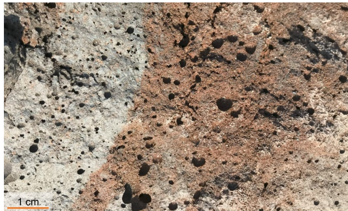
Abbildung 34: Aufnahme einer exemplarischen, inhomogenen Konverterschlacke [118]
