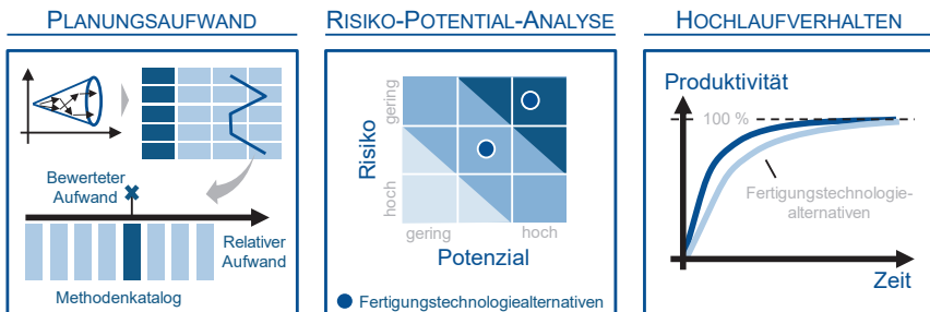
Abbildung 4.2 Methodik zur Auswahl von Fertigungstechnologien im Rahmen der anlauforientierten Technologieplanung nach NAU [NAU12]
