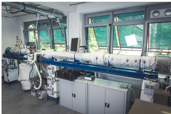
Abbildung 3.3: HGD-Kinetikstoßrohr.
