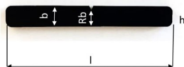
Abbildung Anhang 9: Stabprobekörper Kerbschlagbiegeprüfung nach ISO 179 (Quelle: eigene Darstellung)
