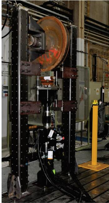
Abb. 4.3: Prüfstand zur Erzeugung von Rad-Schiene-Kontaktabdrücken
