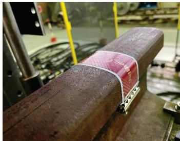
*Abb. 4.4: Einbringung eines Kohlepapiers in Kombination mit einem herkömmlichen Papier im Rad-Schiene-Kontakt*
