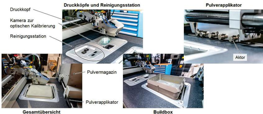
**Bild 4-1:** Binder Jetting Maschine DM P2500 der Firma DIGITAL METAL AB
