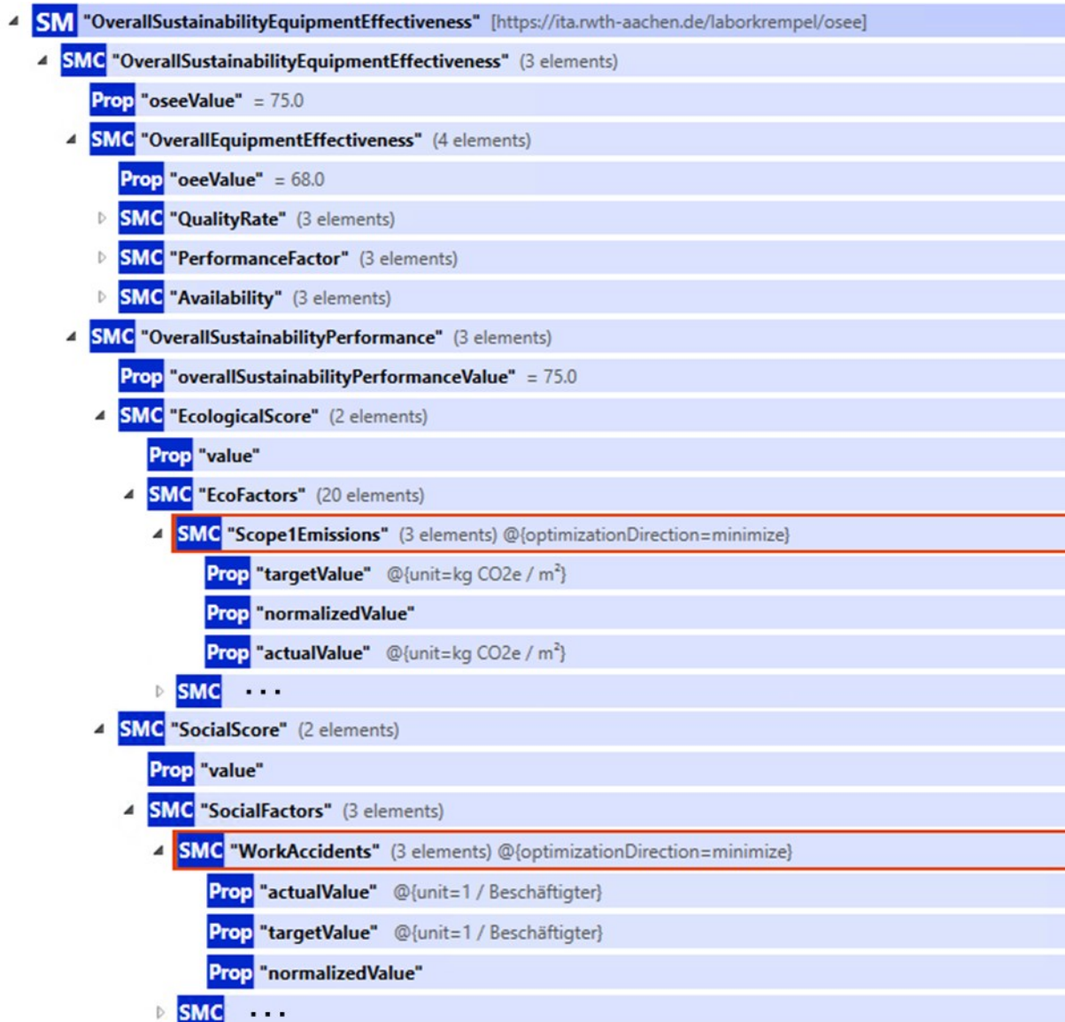
Abb. 3.3: Ansicht des OSEE-Teilmodells im AASX Package Explorer
