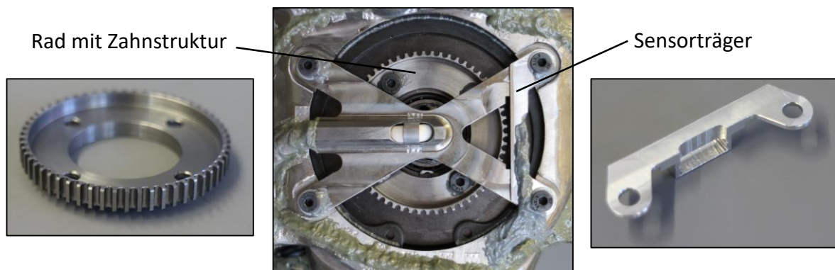
Abb. 3.5: Applikation des GMR-Sensors zur Erfassung der Rotation des Kolbenbolzens
