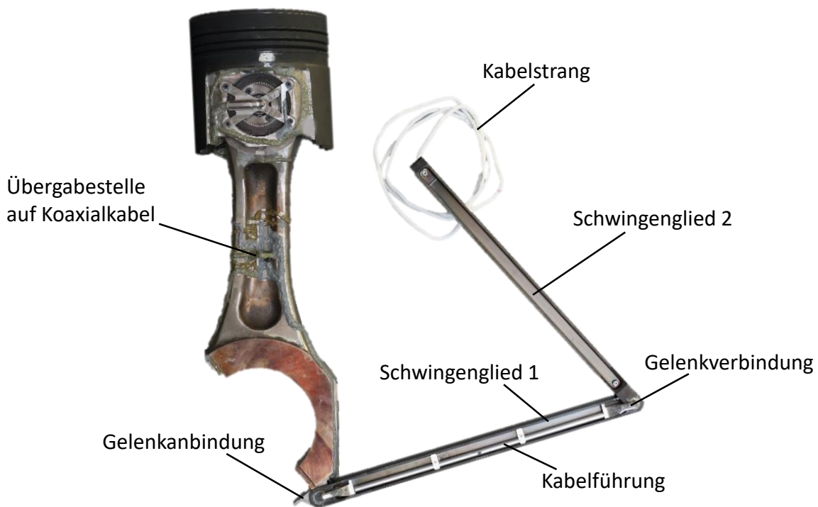
Abb. 3.7: Appliziertes Laufzeug mit Kabelverlegung durch Messschwinge
