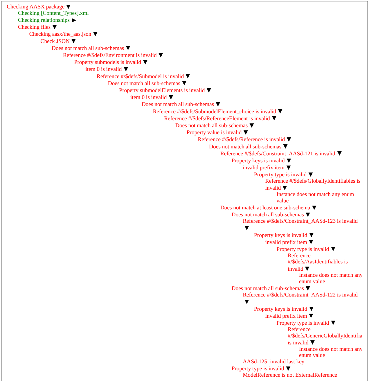
Abbildung 4.4: Beispielausgabe für eine fehlerhafte Serialisierung (Überprüfung mit JSON-Schema)
