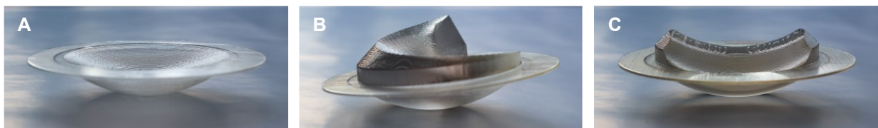
Abbildung 5.6: Fotos der 3D-gedruckten Linsen für die axiale Fokusverschiebung (A), die Fokusvergrößerung (B) und für einen Linienfokus in radialer Richtung (C).
