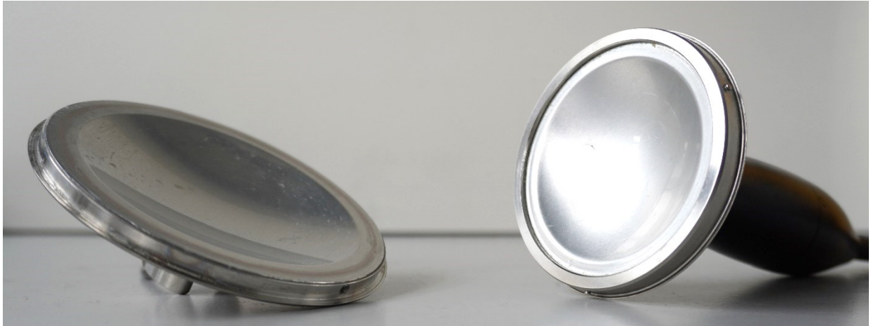
Abbildung 4.2: Therapeutische Stoßwellenwandler: F10G10 (links) und F07G3 (rechts).
