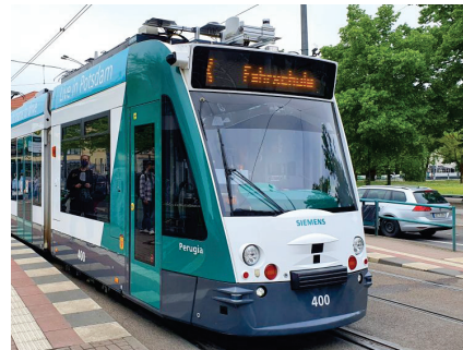
(b) Prototyp der autonomen Tram am Erprobungsträger Wagen 400 des Verkehrsbetriebs in Potsdam [R. Leichsenring]
