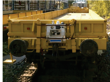
(b) Güterwagen mit angehängter Sensor-einheit [R. Pfaff]
