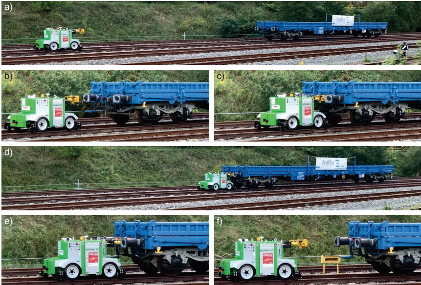
Abb. 7.4: Experimentelle Durchführung des inkrementellen Rangierens mit Kuppelvorgang
