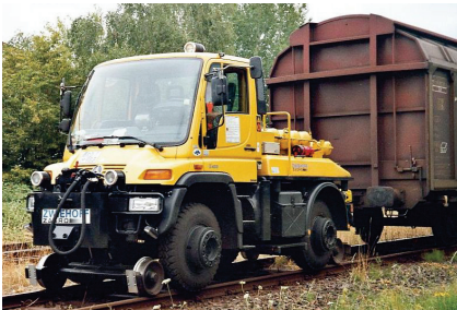
(a) Zweiwege-Rangierfahrzeug auf Basis des Uni-mog U400 [LosHawlos, CC BY-SA 3.0]
