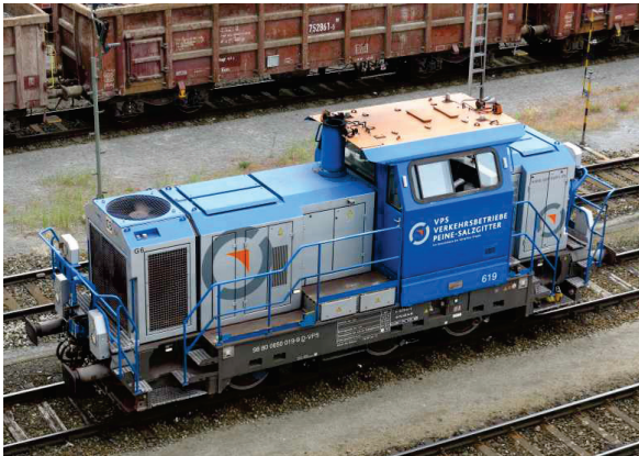
Abb. 2.14: Eine Rangierlokomotive des Typs Vossloh G6 [TeWeBs, CC BY-SA 4.0]
