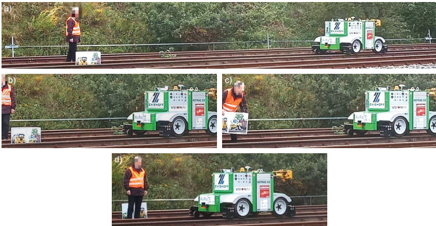
Abb. 7.6: Experimentelle Durchführung der Hinderniserkennung im Schienenmodus
