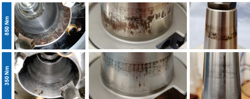
Abbildung 4.7: Verschleiß am SK-A 40 bei unterschiedlichem Biegemoment Wear on SK-A 40 at different bending torques
