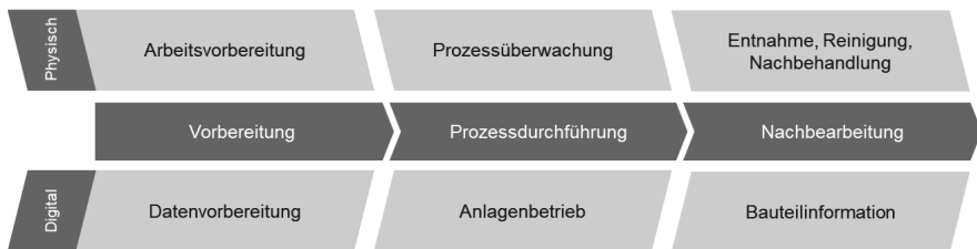
Abbildung 2.6: Prozesskette der additiven Fertigung i.A. VDMA AM Roadmap 56
