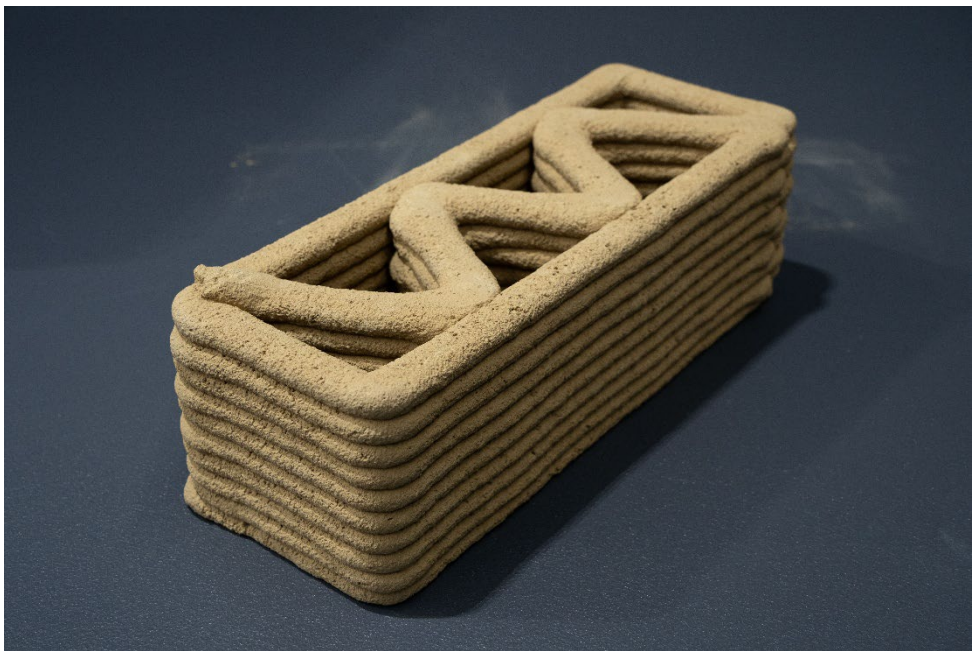
Schichtweiser Aufbau von Bauteilen Gezielte Auftragung von Material
