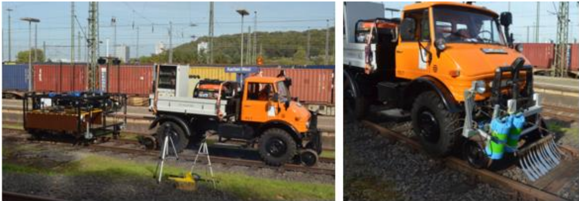
Abbildung 30: Gesamtsystem aus Zugfahrzeug und Geräteträger (links), Vergrämungseinrichtung vorne am Zugfahrzeug aus lautstärkemaximierten Metalllamellen (rechts).
