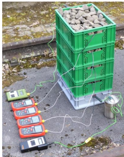
Abbildung 38: Versuchsaufbau Temperaturmessung in verschiedenen Schotterstichten.
