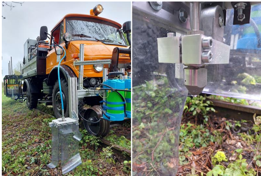
Abbildung 11: Ansicht der Düse zur Anwendung des Druckwasser-Verfahrens.
