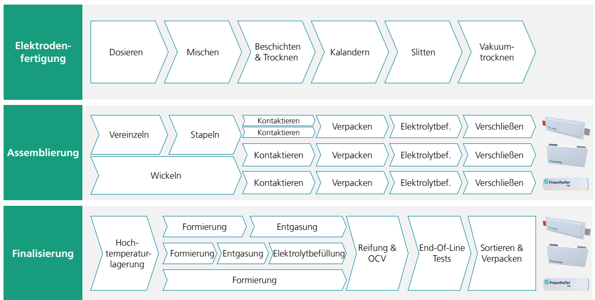
Abbildung 2.14: Die Produktionsprozesse der Lithium-Ionen-Batteriezelle, vertikal gruppiert in die Hauptbereiche Elektrodenfertigung, Assemblierung und Finalisierung. Innerhalb dieser Hauptgruppen unterscheiden sich die Produktionsabläufe teilweise je nach Zellformat, markiert durch die gerenderten Zellbilder. (Prozesse basierend auf [KAMP13], Renderings ©Fraunhofer-Forschungsfertigung Batteriezelle FFB)
