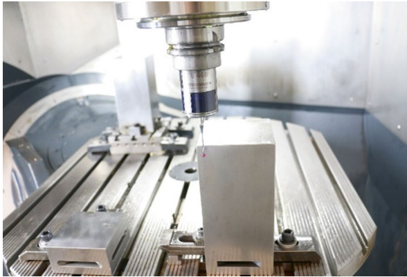
Abb. 11 Objekt-Vermessung mit Heidenhain Messtaster
