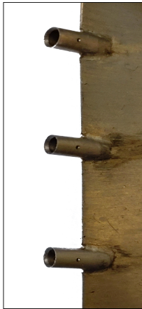
Abbildung 8.1.: Kiel-Sonden an der Schaufelvorderkante
