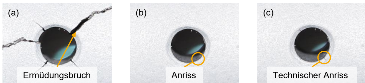
Abbildung 6.1: Definition des Bruchkriteriums (a) sowie des Anrisses (b) und des technischen Anrisses (c)
