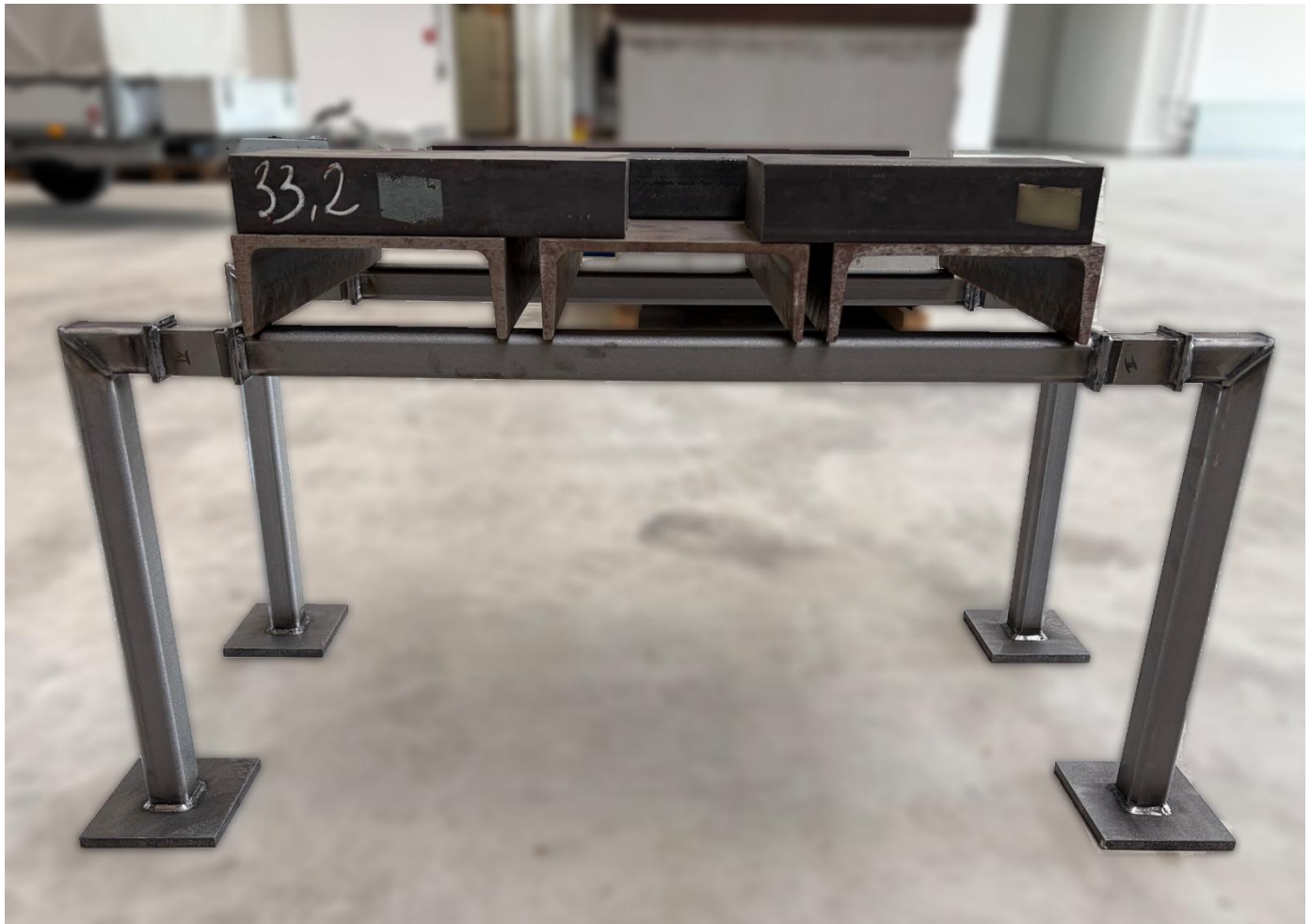
Abbildung 80: Demonstrator unter 120 kg Last.
