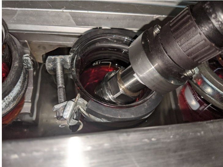
Abbildung 14: Aufbau für die VLP-Sensormessungen der Proben aus der Langzeitlagerung
