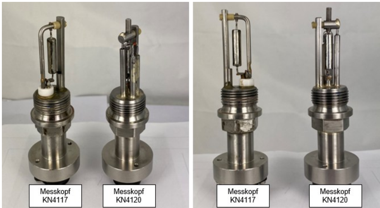
Abbildung 13: Viskositäts-, Leitfähigkeits- und Permittivitäts-Sensorköpfe (VLP-Sensor) des Lubricon-Messsystems
