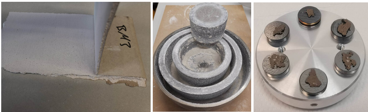
Abbildung E 1: Probenvorbereitung von Gips aus GKP zur Analyse der Phasenzusammensetzung. Freilegung des Gipskerns von GKP (links), gemahlener Gips (mitte), Gipsbruchstücke mit Kohlestoff bedampft auf Probehalter (rechts) (eigene Aufnahmen)
