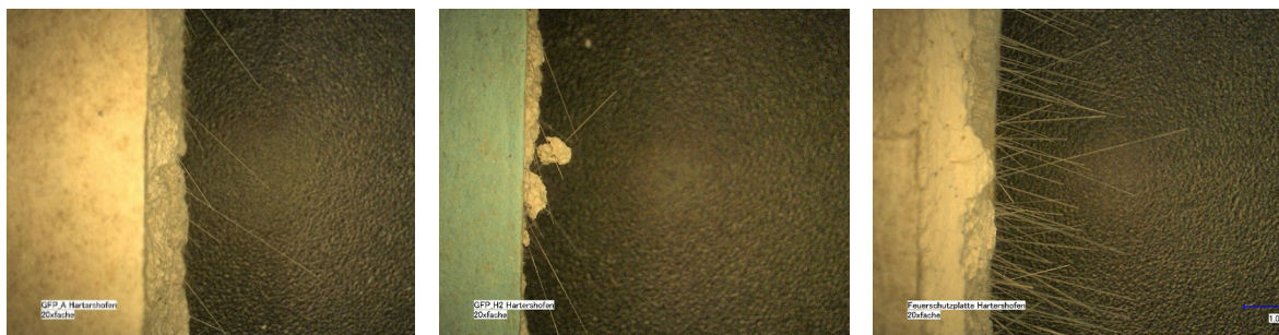
Abbildung F 1: 20x- fache Vergrößerung der Bruchkante von GKP aus dem Werk Hartershofen der Typen A, H2 und DF (von links nach rechts) mit sichtbar eingelagerten Glasfasern
