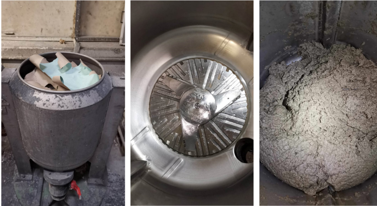
Abbildung E 2: Faserstoff im Pulper (links), Schneidwerkzeug des Pulpers (mitte) und aufgelöster Faserstoff „Pulpe“ (rechts) (eigene Aufnahmen)
