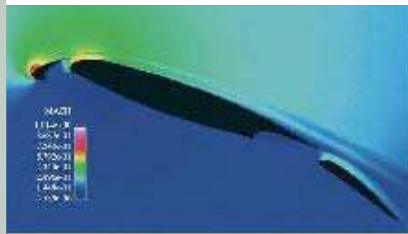
Bild 10: c_p -Wertverteilung für eine Hochauftriebskonfiguration.
