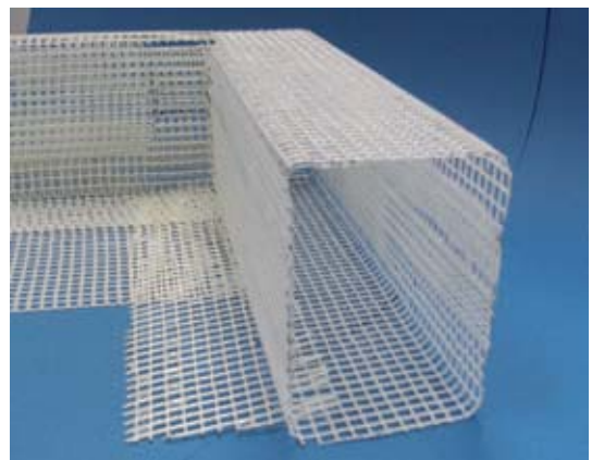
Das textile Bewehrungselement im Bereich des Querjochs mit Einsteckbewehrung
