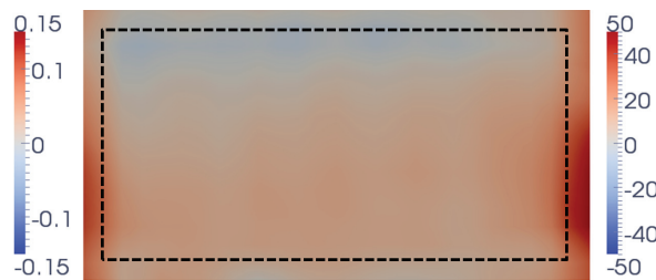
Abbildung 7.21: Differenzbild der lokalen Stromdichteverteilung für den Betriebspunkt i = 0.30 \text{ A cm}^{-2} ; (linke Skala: absolut in A cm -2 ; rechte Skala: relativ in %)
