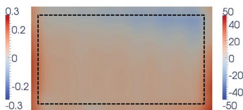
Abbildung 7.12: Differenzbild der lokalen Stromdichteverteilung für den Betriebspunkt i = 0.60 \text{ A cm}^{-2} ; (linke Skala: absolut in \text{A cm}^{-2} ; rechte Skala: relativ in %)
