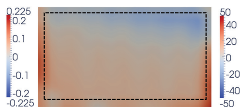
Abbildung 7.10: Differenzbild der lokalen Stromdichteverteilung für den Betriebspunkt i = 0.45 \text{ A cm}^{-2} ; (linke Skala: absolut in A cm -2 ; rechte Skala: relativ in %)
