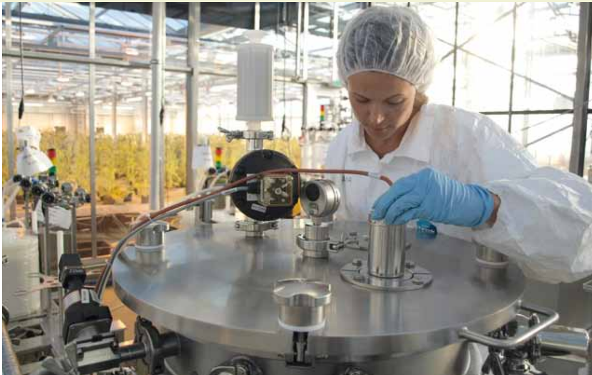
Bild 2: Aufschluss der Biomasse und erste Schritte zur Reinigung des in Tabak produzierten 2G12-Antikörpers: Arbeiten an der Pilotanlage.
