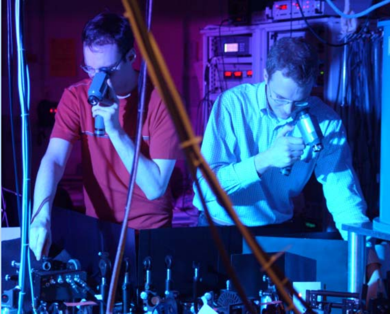
Justage der Laserstrahlen an der zeitaufgelösten Pump-Probe-Spektroskopie-Anlage des II. Physikalischen Instituts der RWTH Aachen. Foto: Peter Winandy
