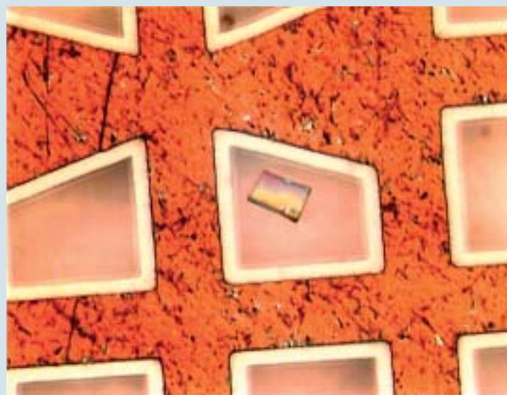
Bild 2b: Lichtmikroskopische Aufnahme der dünnen TEM-Lamelle nach der Entnahme mit-
