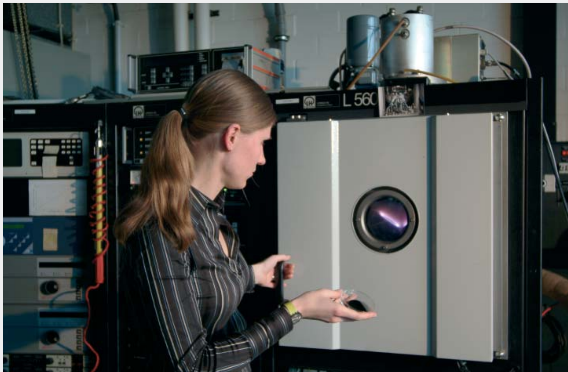
Physical Vapour Deposition-Anlage zur Beschichtung von Silizium-Wafern. Foto: Peter Winandy
