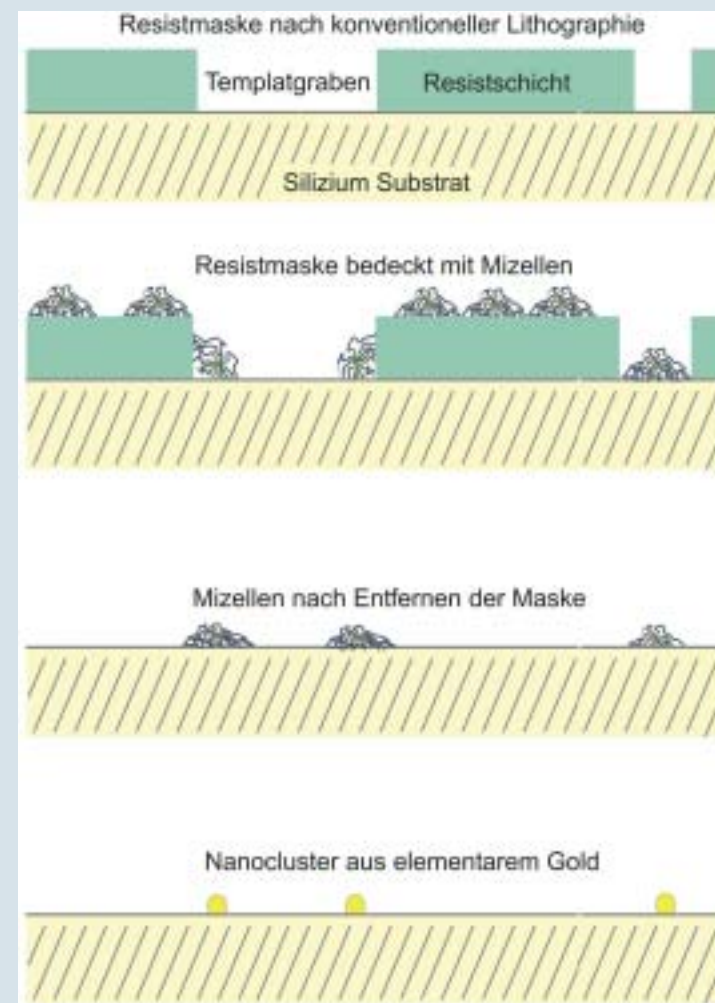
Bild 1: Verfahren zur Abscheidung von Goldclustern in aperiodischen Mustern.
