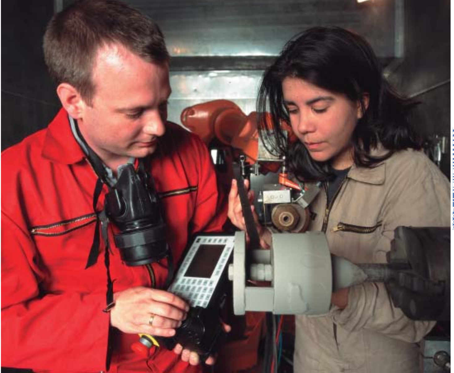
Einstellen des Spritzabstandes zwischen Brenner und Substrat.
