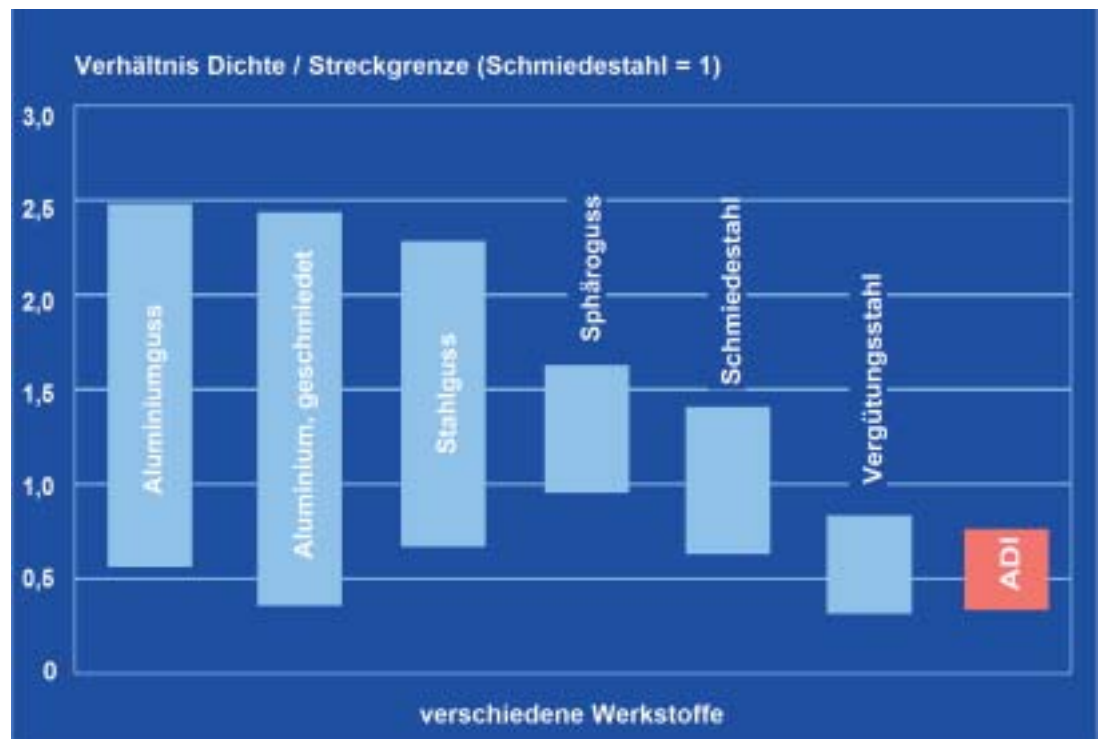
Bild 2: Leichtbaupotenzial des ADI-Gusseisens am Beispiel des Verhältnisses von Dichte zu Streckgrenze (Quelle: Applied Process).
