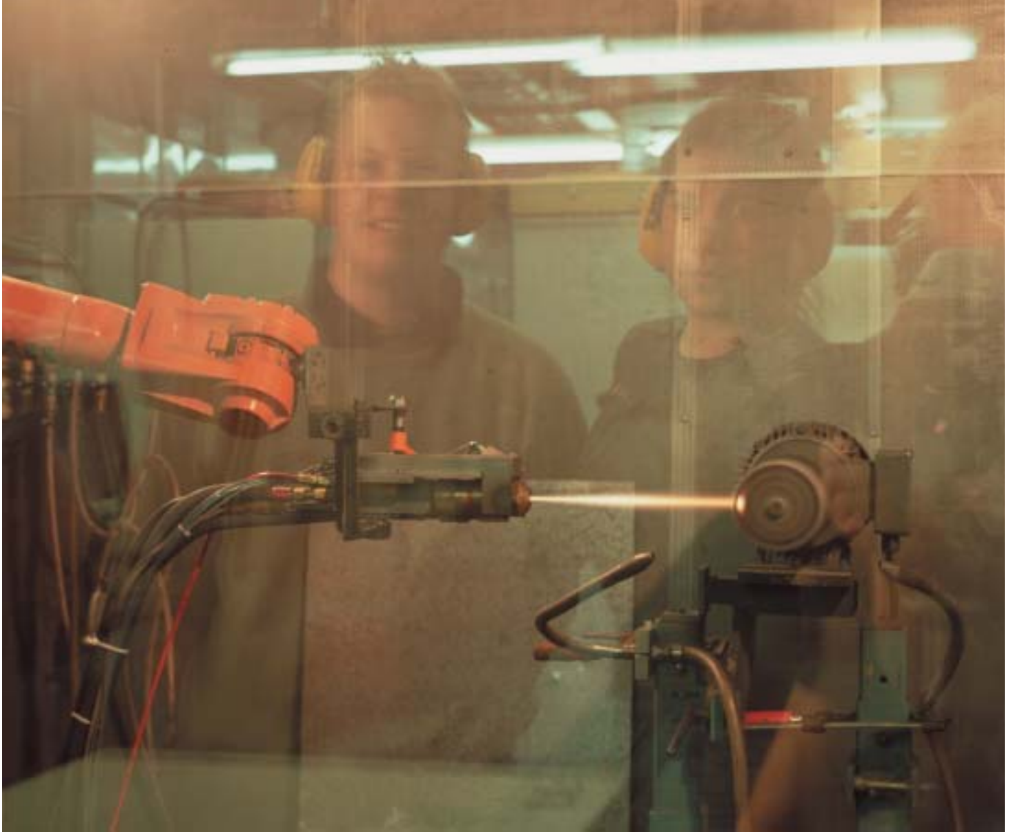
Thermisches Spritzen einer Hochtemperatur-Oxidationsschutzschicht für die Gasturbinenanwendung.
