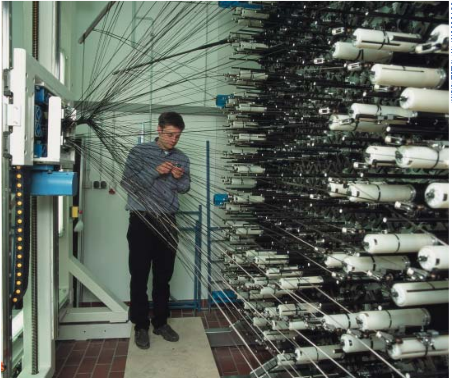
Prüfen der Fadenzugkraft im laufenden Prozess an der dreidimensionalen Flechtmaschine.
