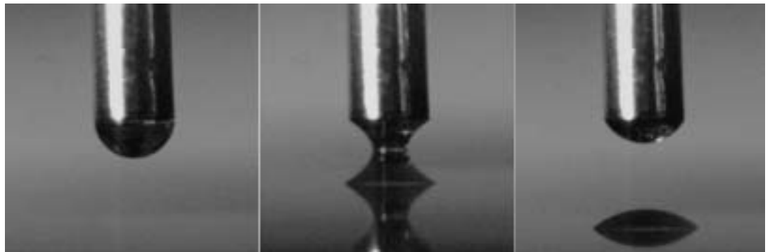
Bild 2: Berührender Klebstoffauftrag mit Kapillare.
