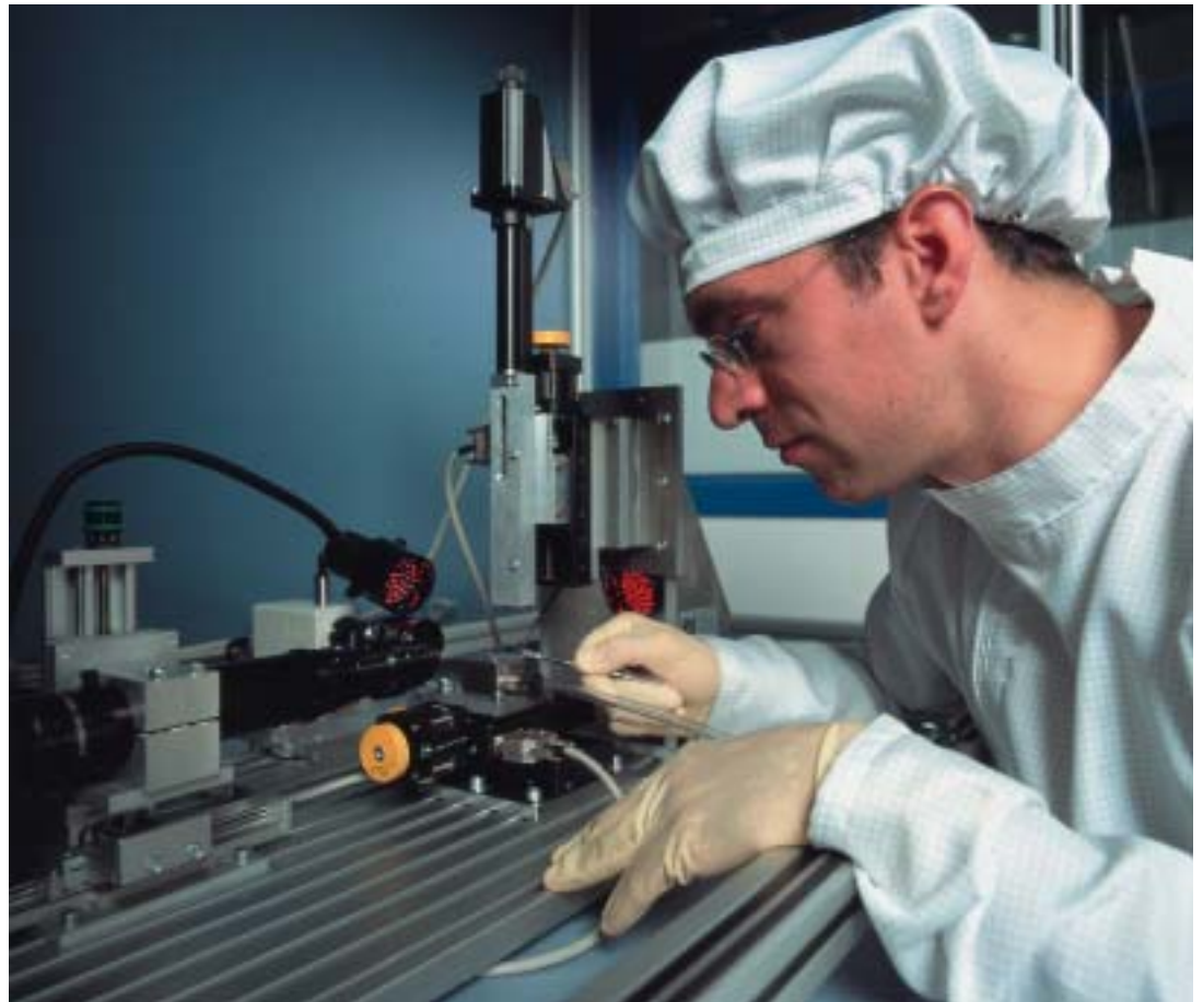
Einrichten der Mikrodosieranlage für Polymere zum Kleben eines Mikromischer-Bauteils für die Biotechnologie.
