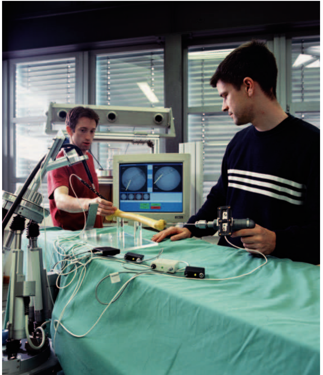
Navigation und Robotik zur Entfernung von Knochenzement in der Hüftrevisions-Endoprothetik.
