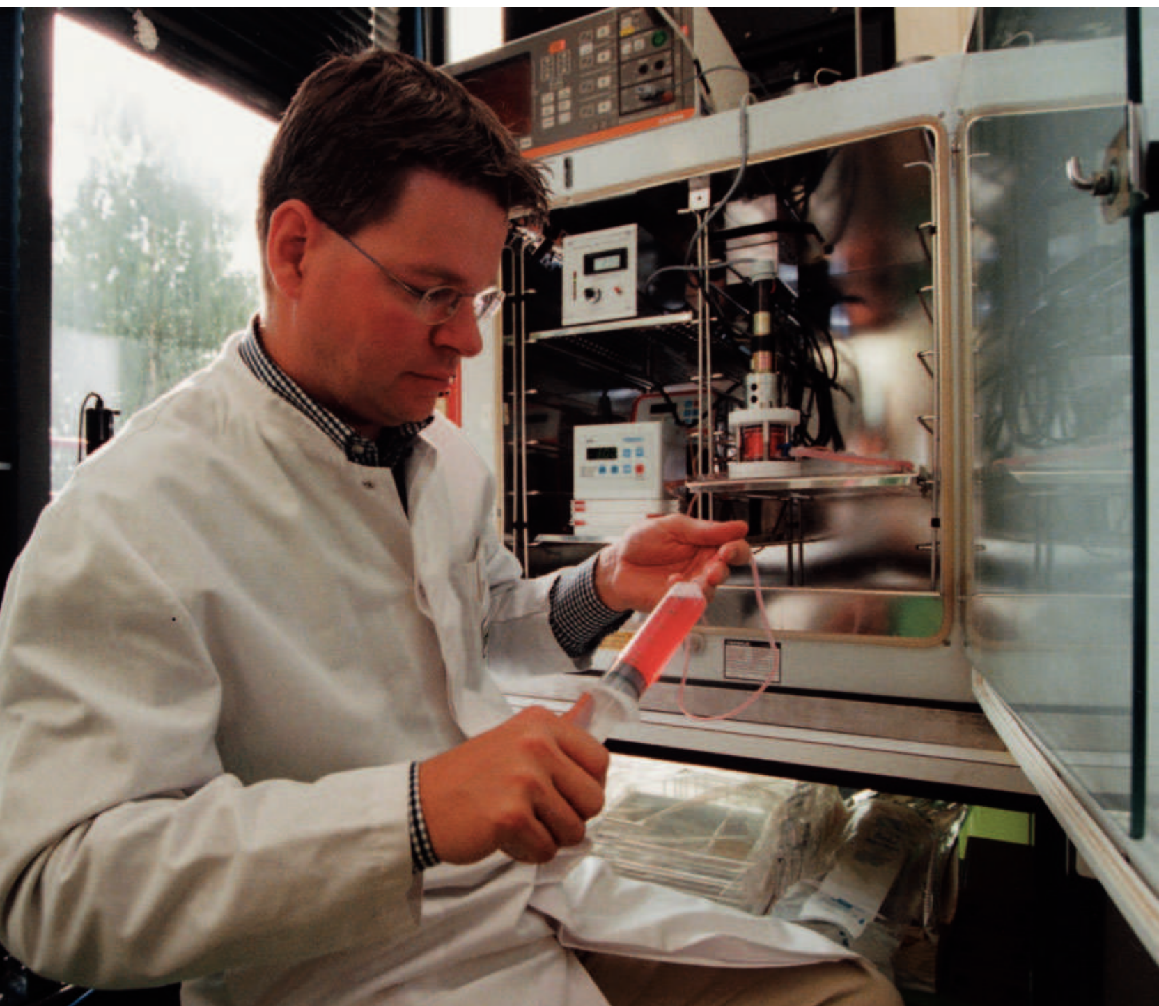
Bild 1: Bioreaktor zur Kultivierung von Herzklappensegeln im zweidimensionalen Scherfeld. Foto: Peter Winandy
