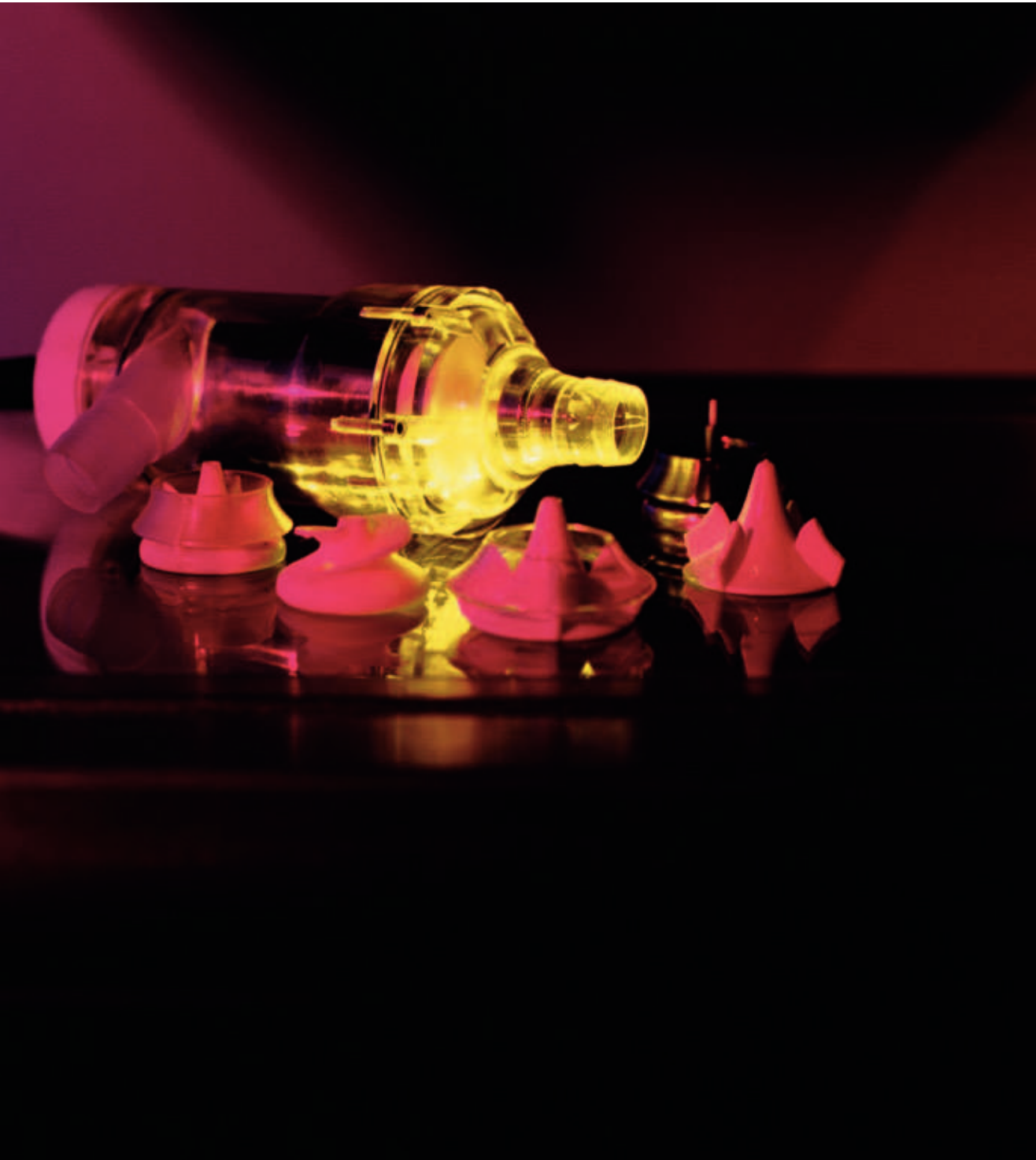
Lauf­rad­va­ria­tio­nen für Blut­pum­pen. Su­che nach der op­ti­ma­len Ge­o­met­rie für eine bes­se­re Blut­för­de­rung, we­ni­ger Blut­schä­di­gung (Hä­mo­lyse) und we­ni­ger Ge­rinnsel­neigung (Thromben­bil­dung). Foto: Peter Winandy
