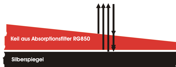
Abbildung 5.2.7: Schematische Darstellung des Probenaufbaus – Keil aus dem Glas des Absorptionsfilter RG850 auf einem Silberspiegel
