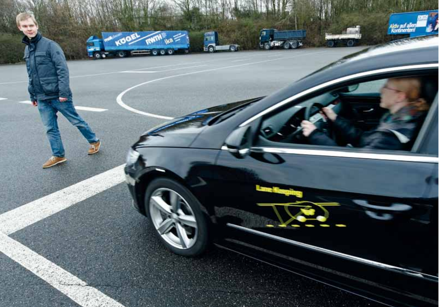
Bild 5: Automatische Notbremsung in der Anwendung Foto: Peter Winandy
