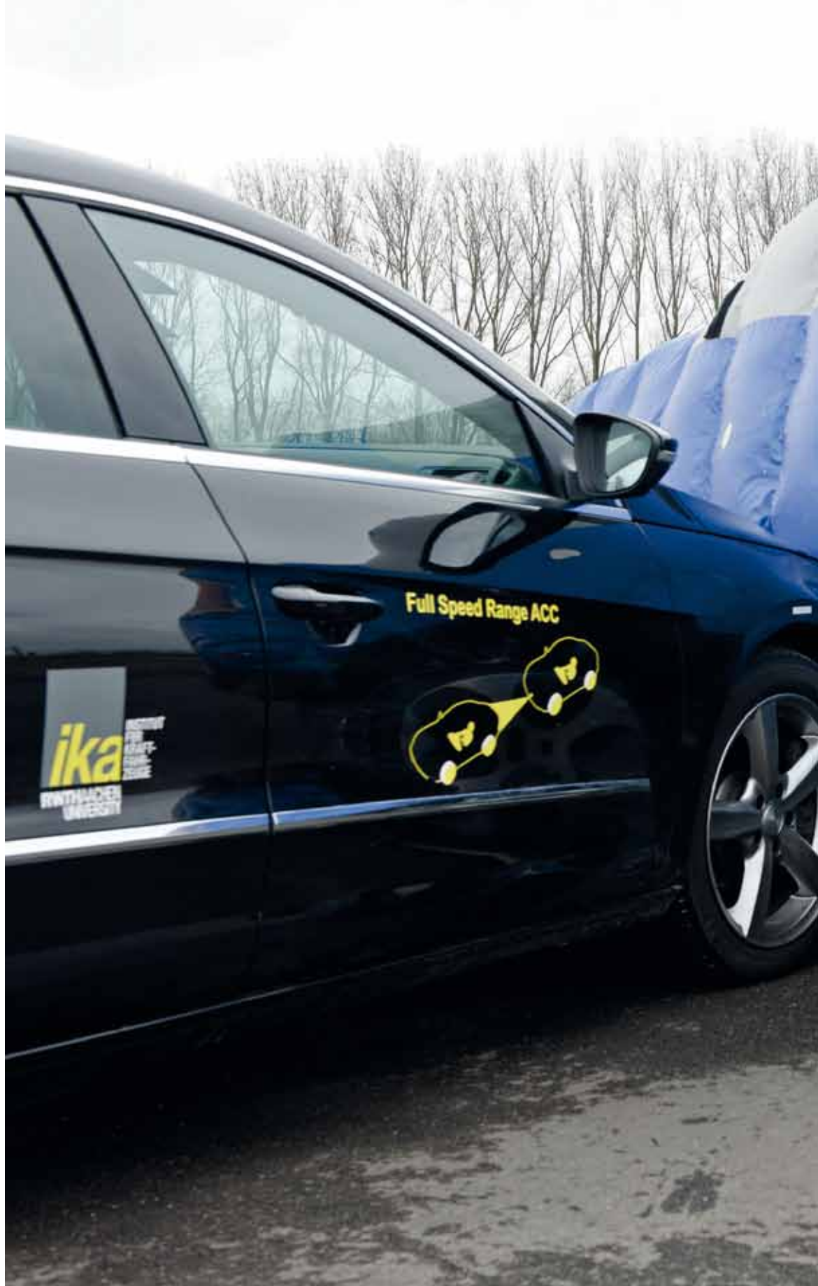
Bild 3: Adaptive Cruise Control in der Erprobung mit einem „Balloon Car“. Foto: Peter Winandy
