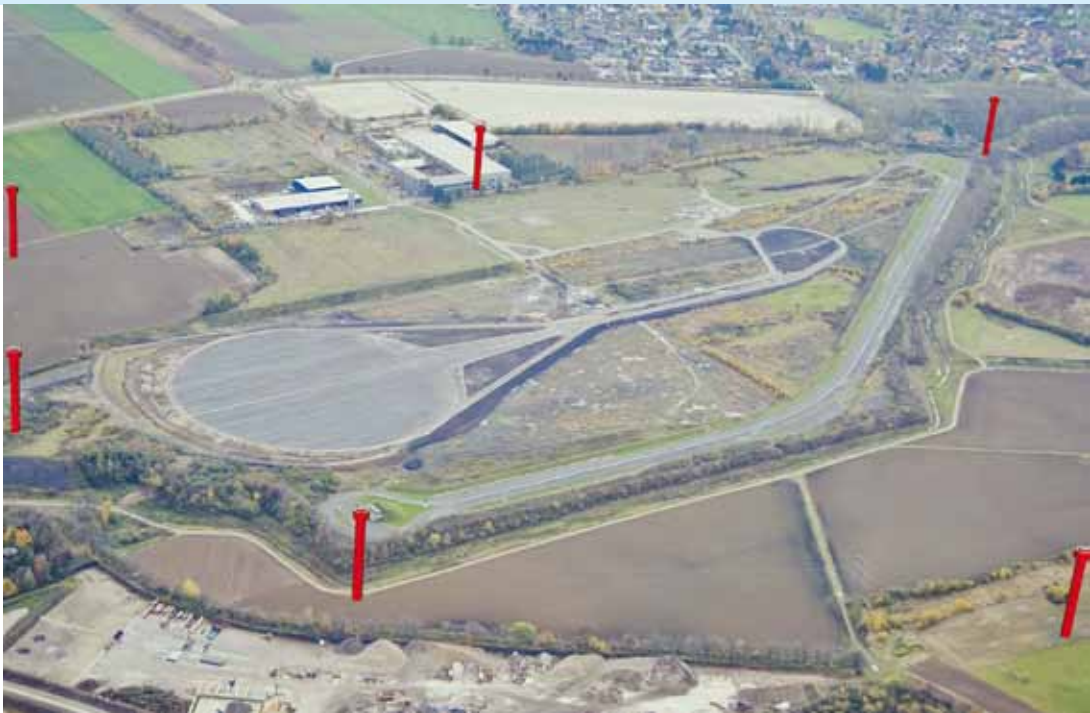
Bild 1: Die roten Markierungen zeigen die Standorte der Pseudoliten des automotiveGATE im ersten Bauabschnitt des ATC. Foto: FEV/IRT
