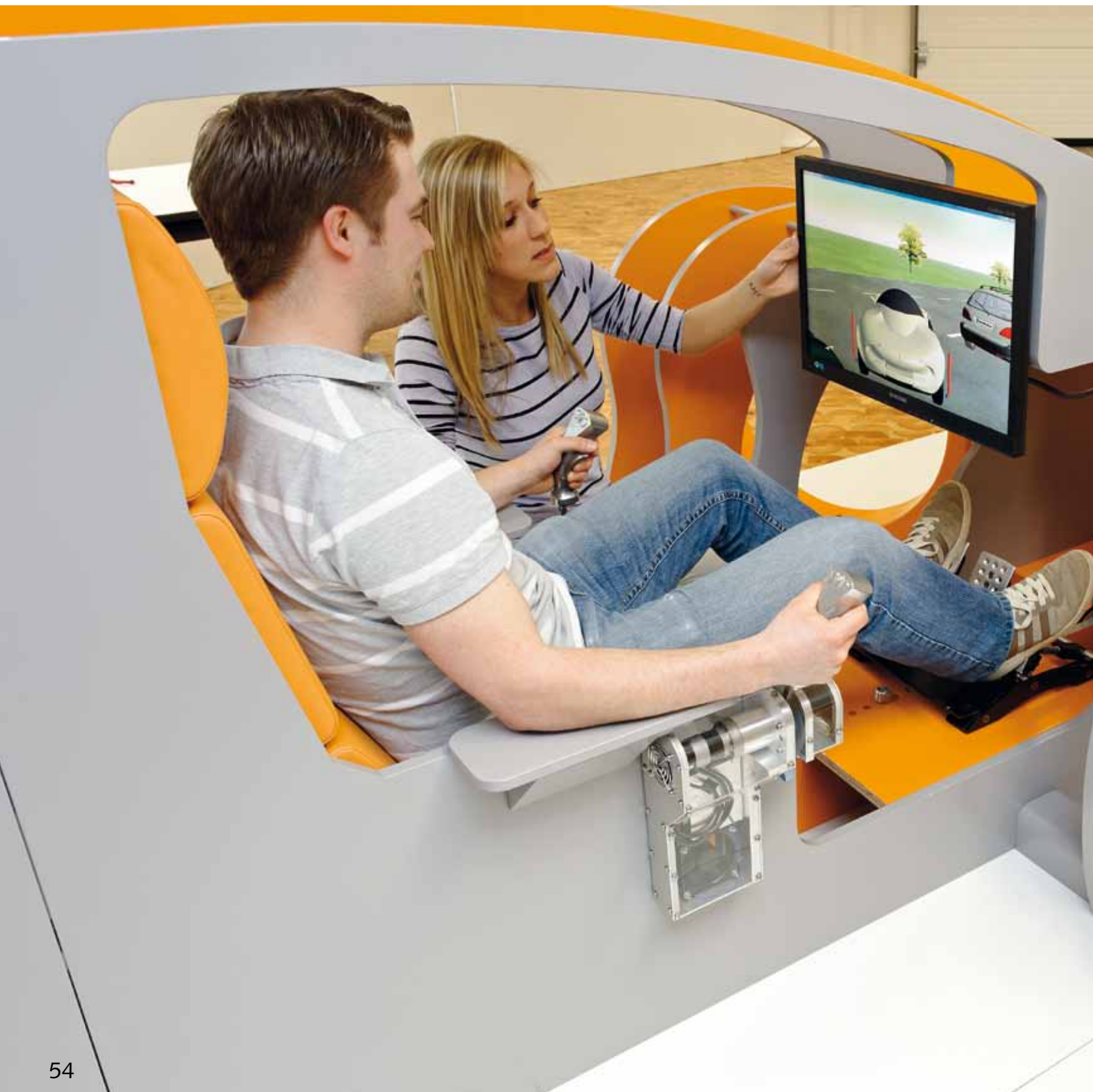
Bild 5: 1:1-Modell des Konzeptfahrzeugs „SpeedE“ mit Side-Stick-Lenkung. Foto: Peter Winandy
