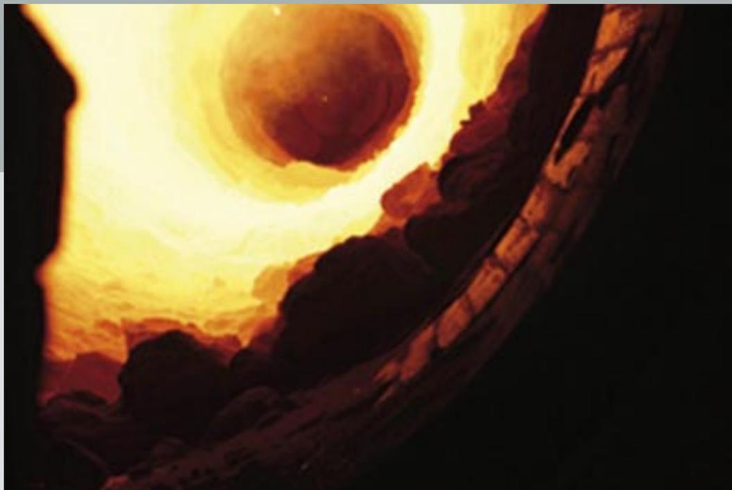
*Bild 1: Innenansicht eines Drehrohrrofens im Betrieb.*
