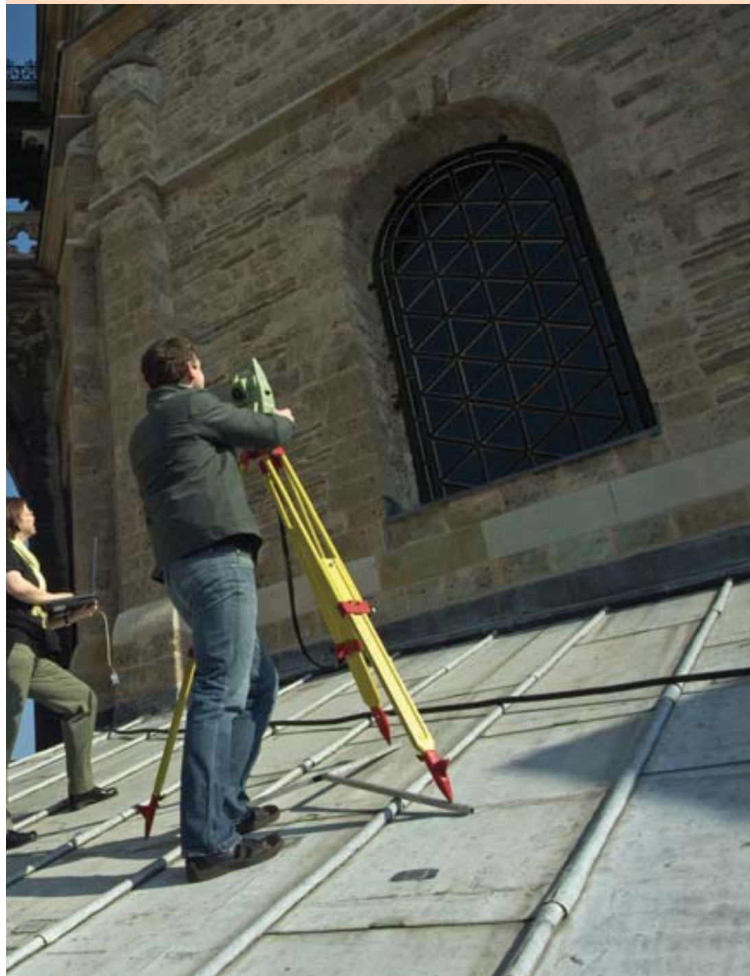
Lydia Konneken und Marc Wiethager vom Lehr- und Forschungsgebiet Denkmalpflege beim Tachymetrischen Aufmessen der Tambour-Fensterlaibun-
