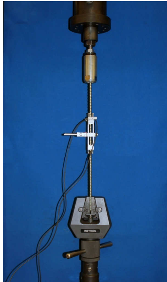
Bild A 1-1: Zugversuche der Schrauben zur Ermittlung der Zugfestigkeit und des Elastizitätsmoduls der Schrauben.
