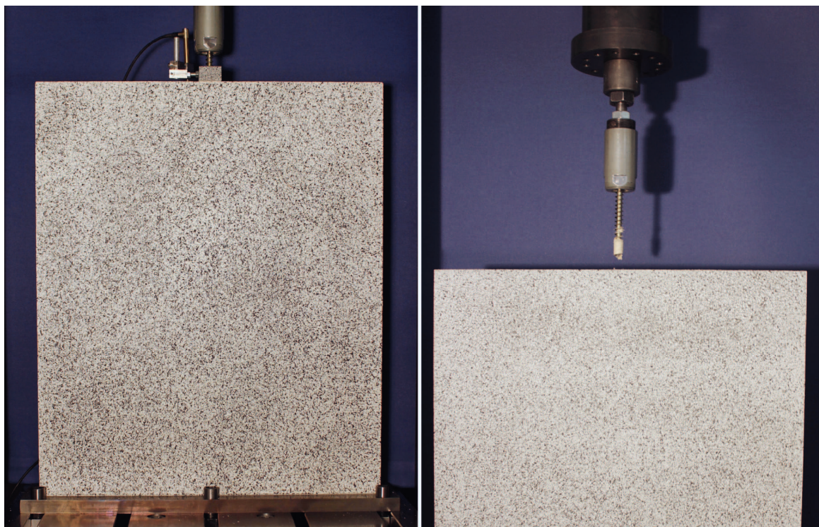
Bild 7-27: Lasteinleitungsversuch: a) der Probekörper während des Versuchs, b) Bruchbild des Körpers durch Materialversagen der Schraube.
