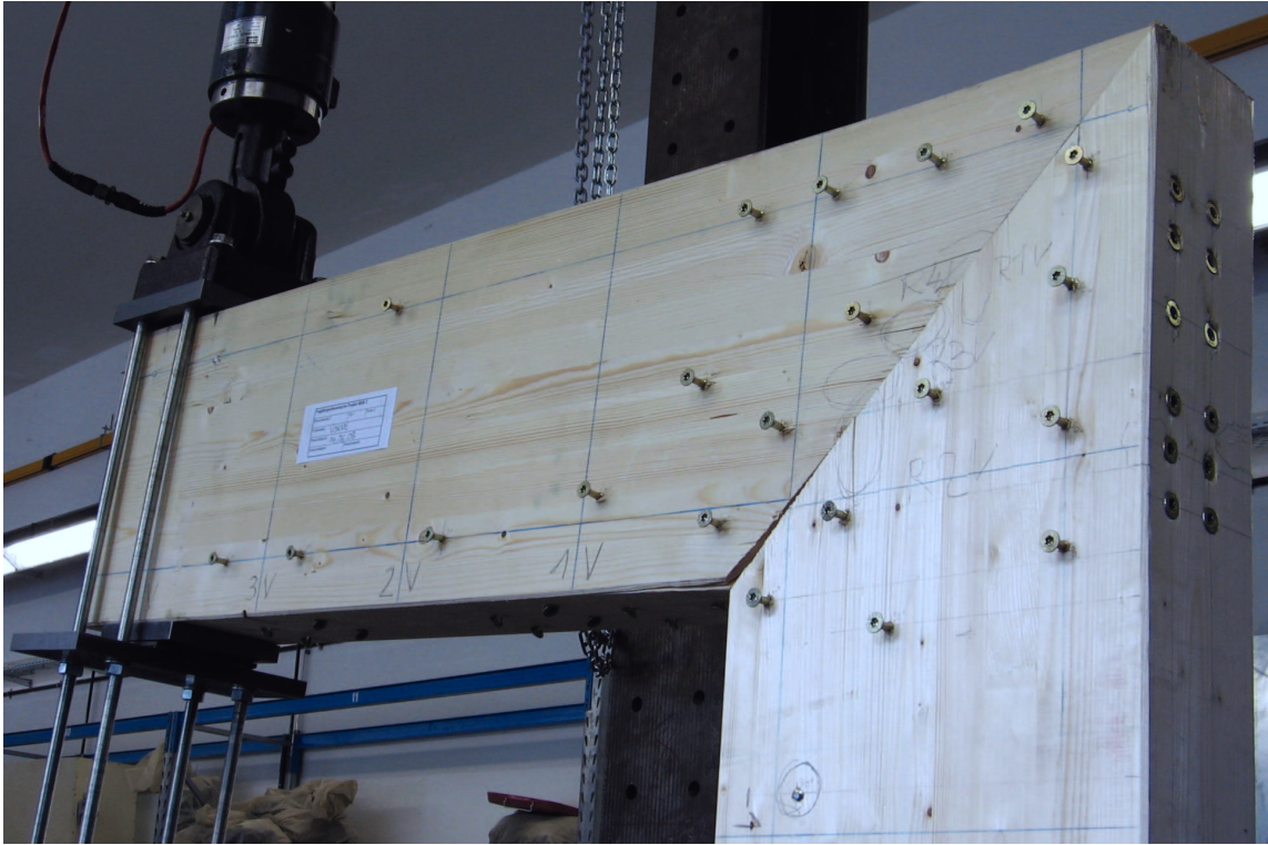
Bild 1-4: Versagenszustand einer mit Vollgewindeschraube bewehrten, biegesteifen Rahmenecke bei positivem Moment [15].
