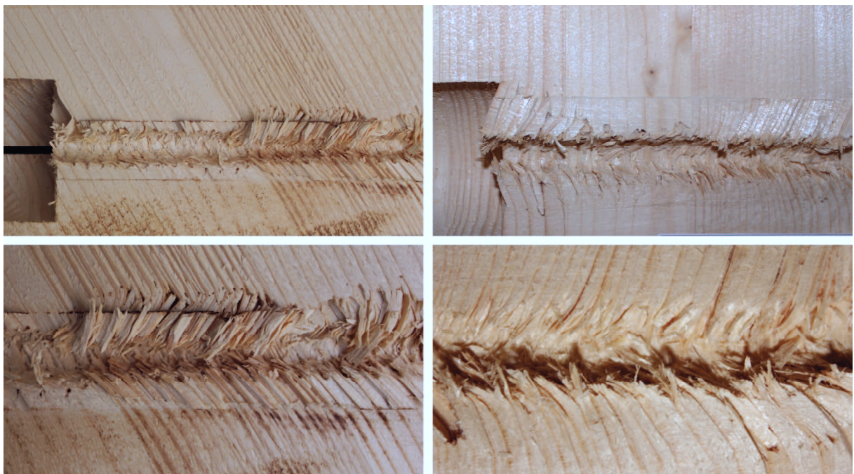
Bild 9-11: Sägeschnitt der Probekörper mit einem Winkel von 60° (links oben und unten) und mit einem Winkel von 90° zur Faserrichtung (rechtwinklig zur Faser, rechts oben und unten).
