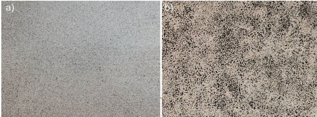
Bild 5-1: Darstellung des stochastischen Musters auf den zu untersuchenden Proben: a) mit feinem dichtem Auftrag für kleine Messflächen, b) mit grober großkörniger Verteilung für die größeren Messfelder.
