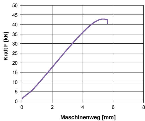
Bild A 3-98: Mittlere Belastung des Versuchskörpers L-D-30-5-60-E-5 (links), L-D-30-5-60-E-6 (rechts) in Abhängigkeit zum Maschinenweg.
