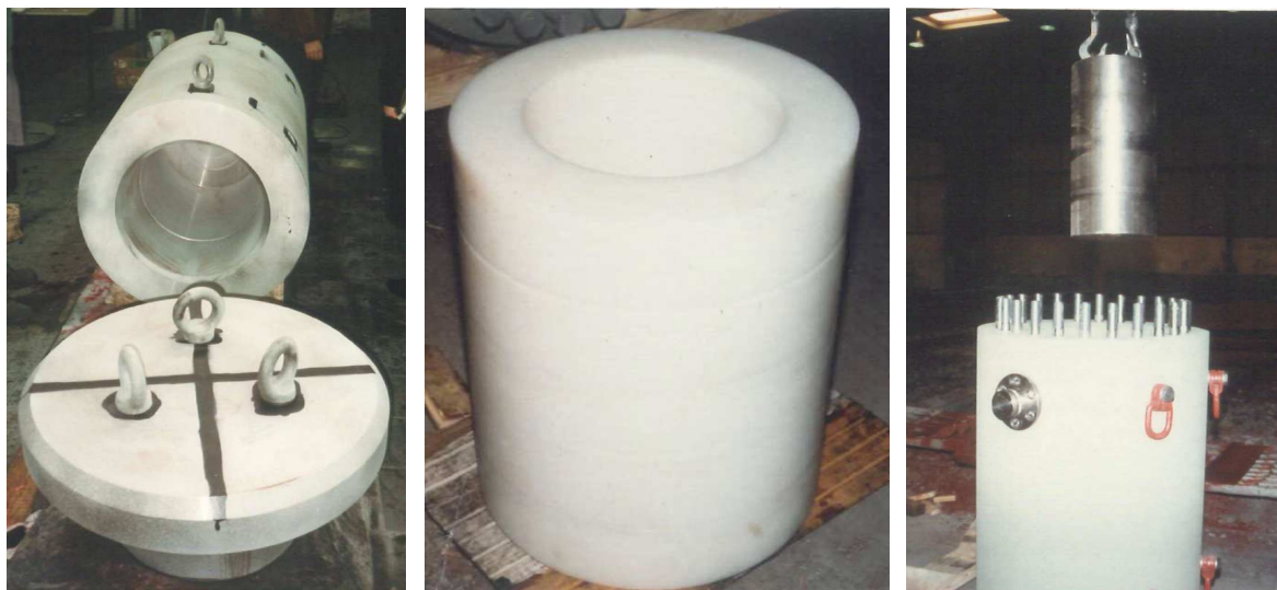
Abbildung 6.1: Foto des Versuchsbehälters direkt nach der Fertigung (links), zylindrische Polyethylen-Abschirmung vor der Assemblierung (Mitte) und Innenbehälter beim Einsetzen in den Abschirmbehälter mit Tragzapfen (rechts) [47]
