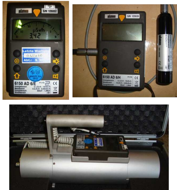
Abbildung D.4: automeasure 6150AD6/E (oben links), Strahlenschutzmessgerät 6150AD6/H mit Außensonde (oben rechts) und Szintillatorsonde 6150AD-b/E mit Strahlenschutzmessgerät 6150AD6/E (unten)
