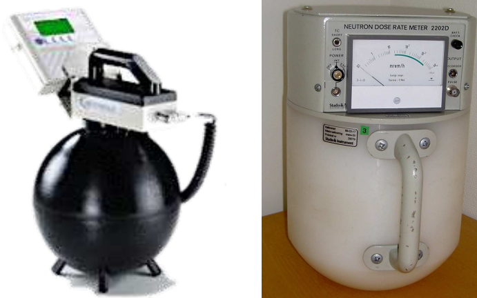
Abbildung D.16: Neutronendosisleistungsmessgeräte LB6411 (links) und 2202D (rechts) [91] und [92]
