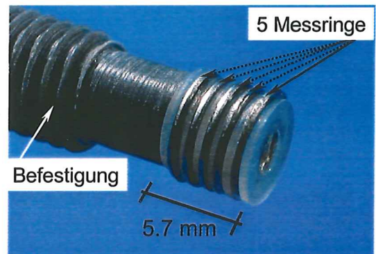
Bild 2: Aufbau der Mini-MRE
