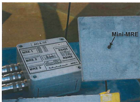
Bild 3: Mini-MRE mit Messelektronik in einer freibewitterten Textilbetonprobe
