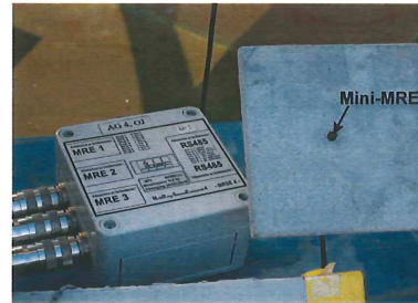
Bild 3: Mini-MRE mit Messelektronik in einer freibewitterten Textilbetonprobe
