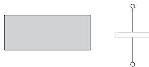
Abbildung 1.11: Zellmembran als Plattenkondensator und das zugehörige Schaltbildsymbol
