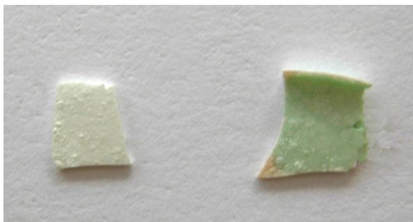
Abbildung 3.3: Foto eines gesinterten \text{LiTaO}_3 -Xerogels. links: LTOa gesintert bei 1100^\circ\text{C} für 48 h. rechts: LTOa gesintert bei 1100^\circ\text{C} für 192 h
