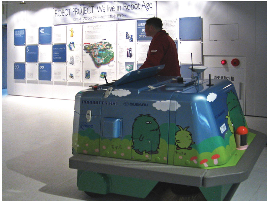
Abbildung 46: Beispiel eines eigentlich autonomen Reinigungsroboters, der zur Sicherheit noch von Menschen geführt wird. Expo in Aishi, Japan, 2005.
