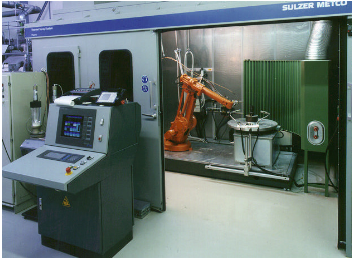
Bild 3.2: Foto einer APS-Anlage mit Roboter (orange) [122]
